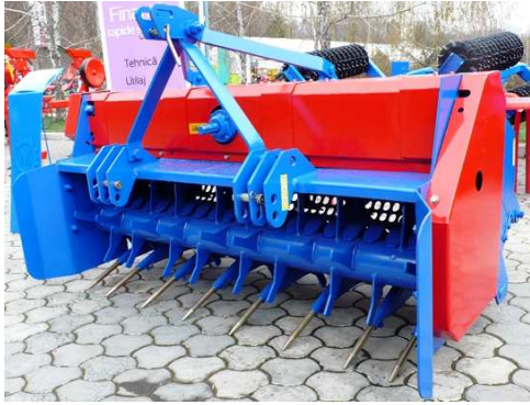
Рис. 1. Подрібнювач виноградної лози FV-1,7 (Молдова)
