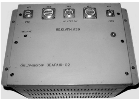
Рис. 6. Бортовий спеціалізований процесор "Збараж-02" для ОС типу "Мир" та "МКС".
