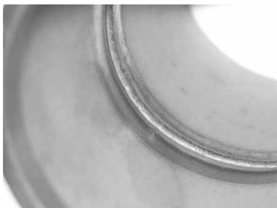
Рис. 5. Формирование обратной стороны шва при орбитальной АТIG-сварке
