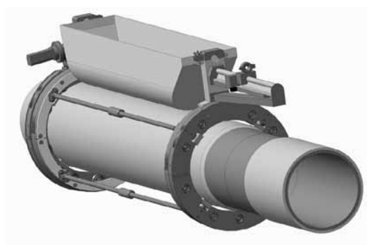
Рис. 12. Устройство для орбитальной намотки стыков труб и баллонов
