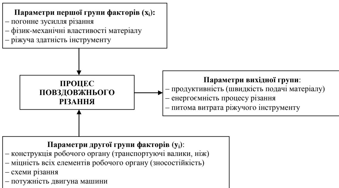
Рис. 1. Схема взаємодії факторів, що діють в процесі повздовжнього різання матеріалу
