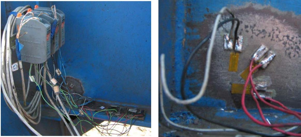
**Рис. 2.** Монтаж розетки тензодатчиков
