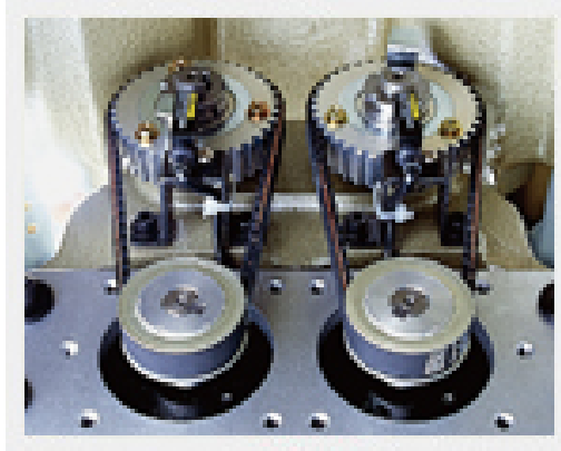
Рис. 3. Подвійний механізм зсуву голочниць
