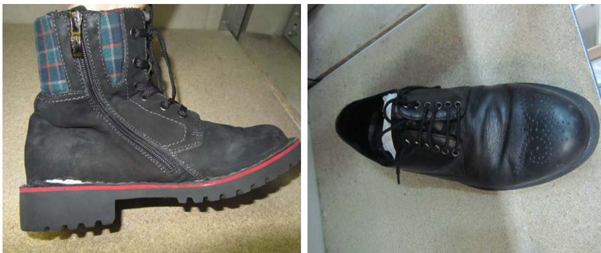
Рис. 2. Зразки дефектного взуття реалізованого магазином «Welfar» а - висмикнення затяжної кромки; б - порив функціональної строчки халяви напівчобітка під ремінцем (нове взуття); в- підріз верху по лінії затяжної кромки виробу; г - дефект лица союзки (ношене взуття)
