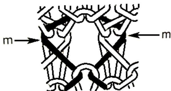
Рис. 2. Побудова петельних стовпчиків напіважурного петельного образу, де є петлі, в яких перенесені дві палички у суміжні петельні стовпчики
