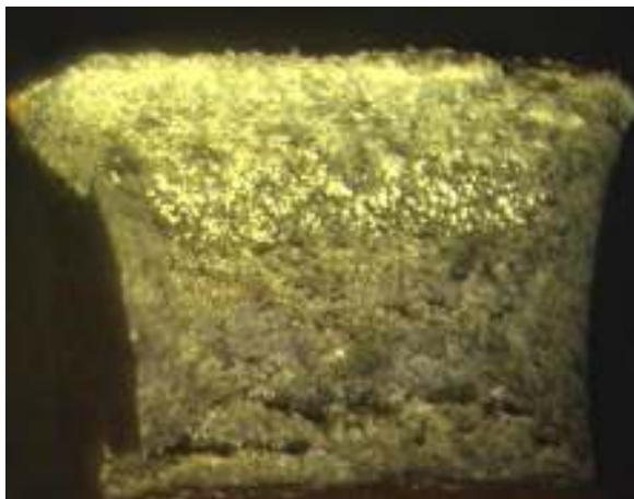
Рисунок 16 – Злам зразка зі сталі 22К з кільцевою орієнтацією концентратора (групи КК) при температурі 50 °С
