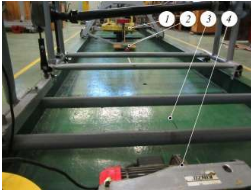
Рисунок 7 – Обладнання для визначення сил опору руху стенда: 1 – стенд; 2 – динамометр; 3 – трос металевий; 4 – електропривід руху стенда
