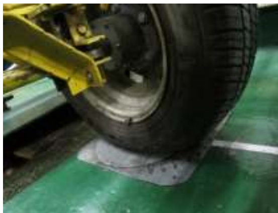
Рисунок 5 – Контактні пластини для зняття напружень в еластичній шині, що виникають при зміні кута перекосу
