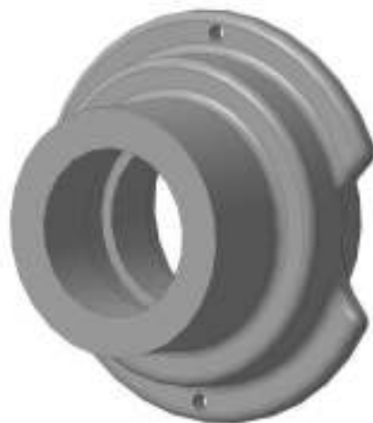
Рисунок 9 – 3D-модель заготовки, виготовленої литтям в піщано-глинисті форми з машинним формуванням суміші
