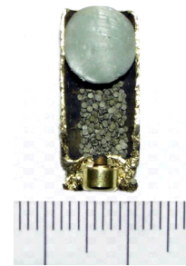
Рис. 3. Загальний вигляд патрону «ПНД-9П» на повздовжньому зрізі
