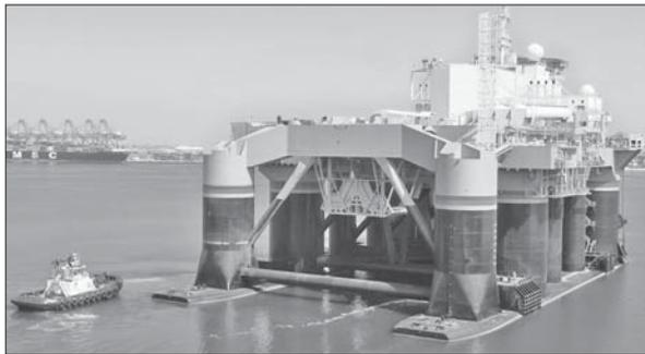
Платформа «Одиссей» — плавучая пусковая установка в проекте «Морской старт»
