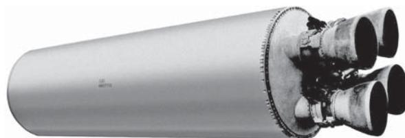
Твердотопливный маршевый двигатель 15Д15 первой ступени МБР 8К99
