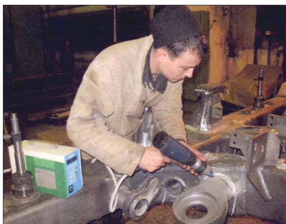
Застосування технології ультразвукової ударної обробки поверхні металевих виробів для зварних з'єднань візка вагона метро
