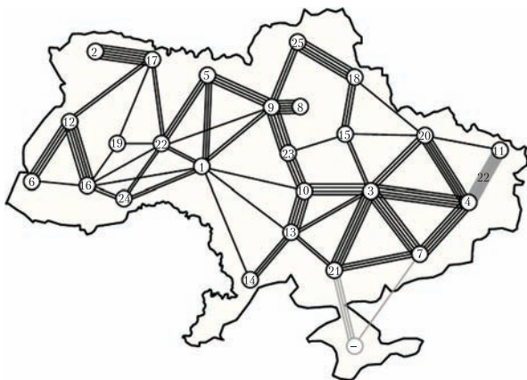
Рис. 7. Агрегована ОЕС України: 26 регіональних енерговузлів, сполучених 133 лініями електропередачі; в енерговузлах розміщено 117 генеруючих блоків, які належать 9 компаніям
