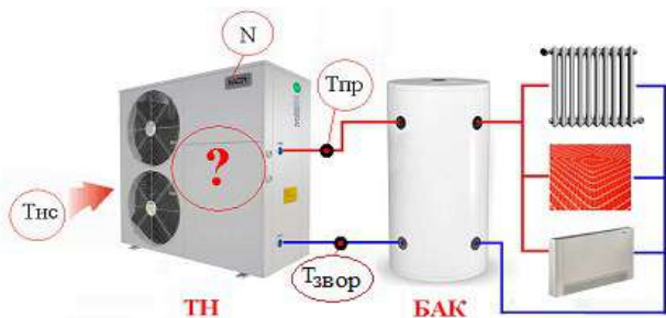
Рис. 3 – Ілюстративна схема параметрів, що замірюються при роботі ТН
