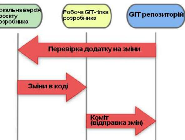
Рис. 6 – Схема роботи з GIT
