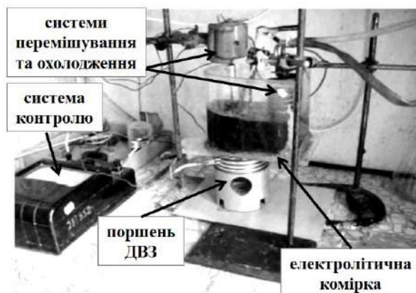
Рис. 1 – Установка для ПЕО-обробки поршня ДВЗ
