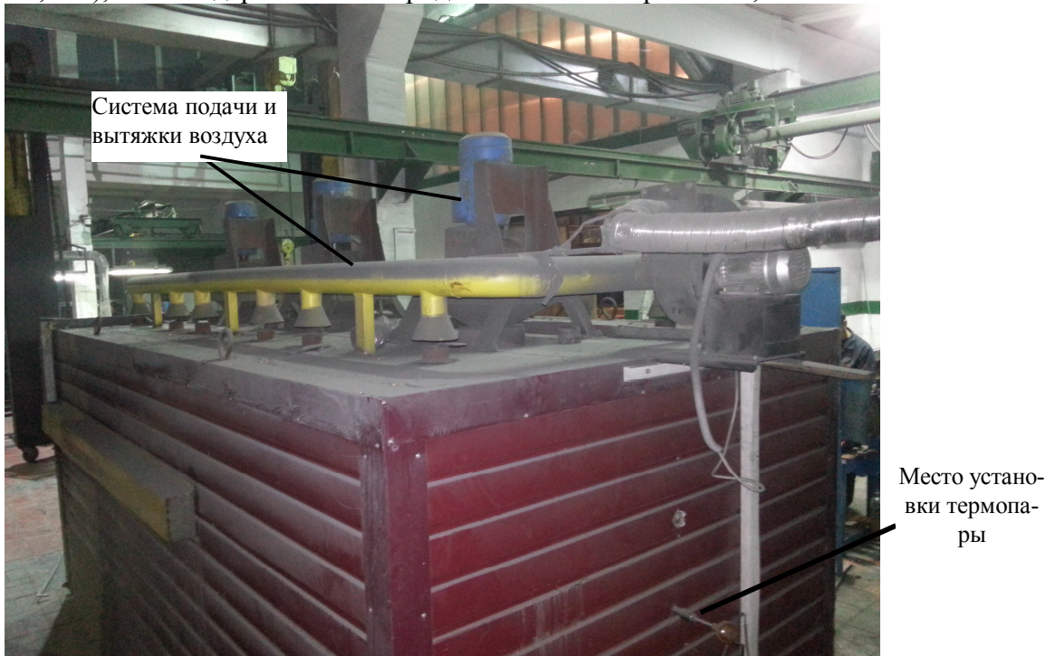
Рис. 2. Система подачи и вытяжки воздуха прокалочной печи
