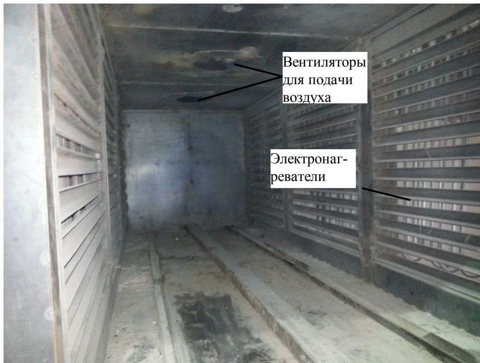
Рис. 1. Внутреннее строение печи
