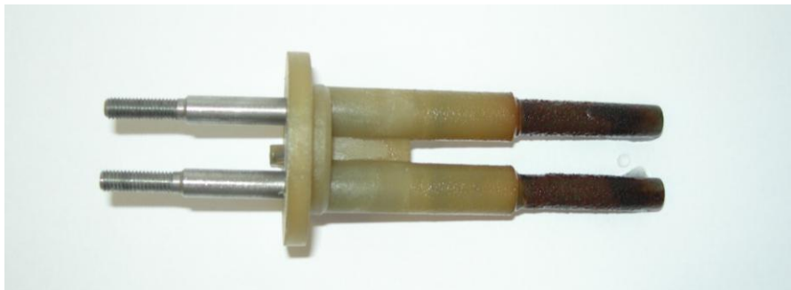
Рис 2 – Внешний вид датчика коррозии после проведения измерений интегральных показателей коррозионной агрессивности воды хозяйственно-бытового назначения, отобранной из РЧВ фильтровальной станции ЗГВ (390 часов измерений)
