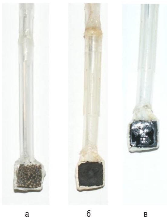
Рис. 4. Зразки анодів. а - титанова основа для отримання анода; б - та ж основа з діоксидно-мангановим захисним підшаром; в - готовий анод з діоксидно-плюмбовим покриттям, що має металевий блиск
