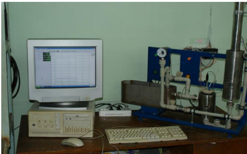
Рис. 1. Фото стенда для безперервних ресурсних випробувань лабораторних зразків анодів
