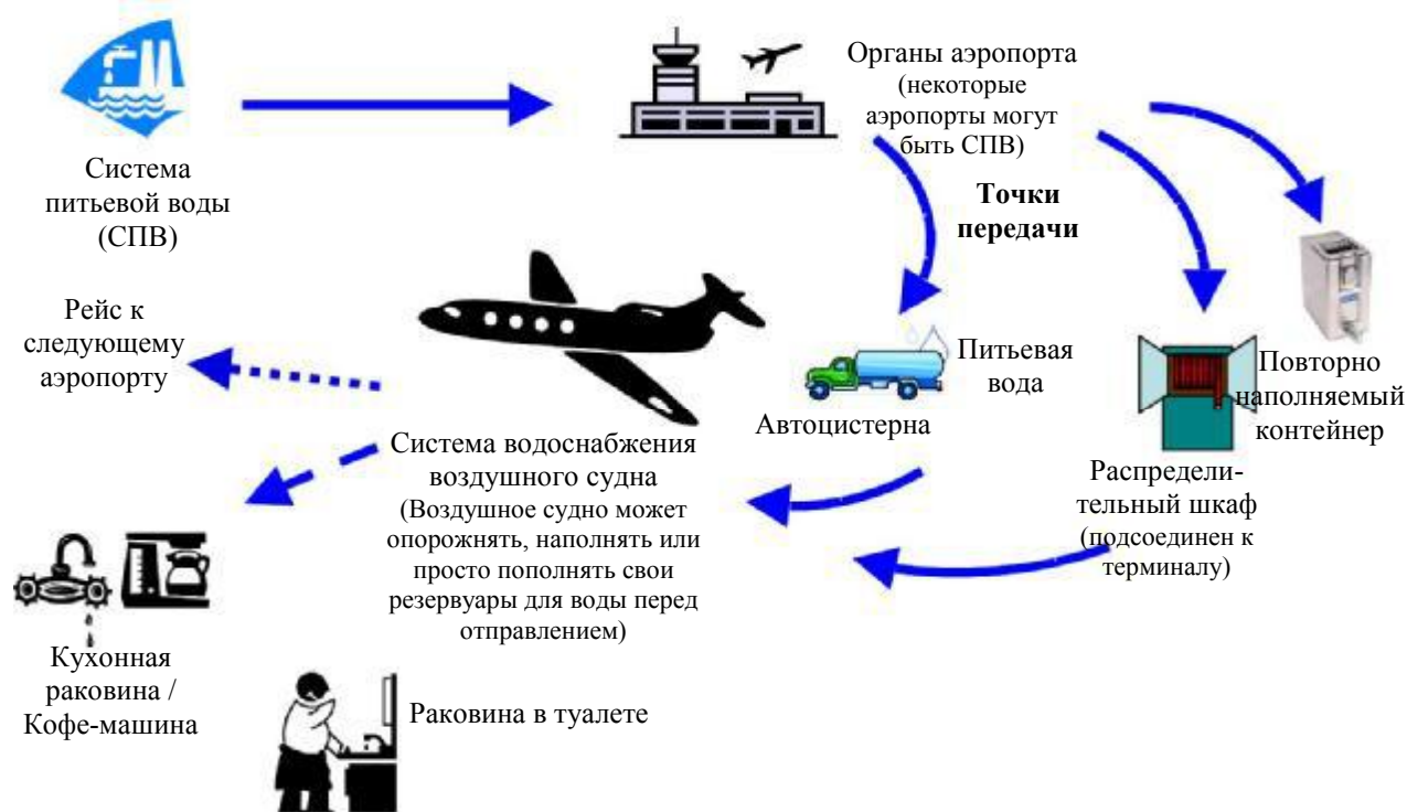
Рис.1. Схема подачи и передачи питьевой воды для воздушного судна (Guide to hygiene and sanitation in aviation (third edition), WHO, 2009)
