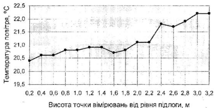
Рис.2 Графік розподілу температури повітря за висотою приміщення
