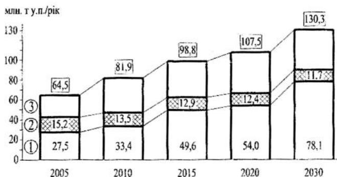
Рис. 1. Виробуток та споживання вугілля в Україні: 1 – електростанції; 2 – комунальне господарство та ін.; 3 – коксохімічна промисловість
