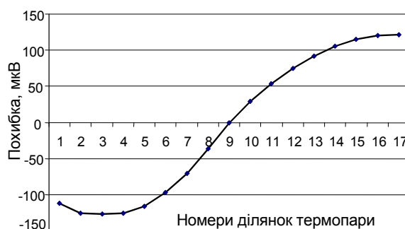
Рис. 2. Похибка від набутої неоднорідності хромелевого електроду звичайної термопари
