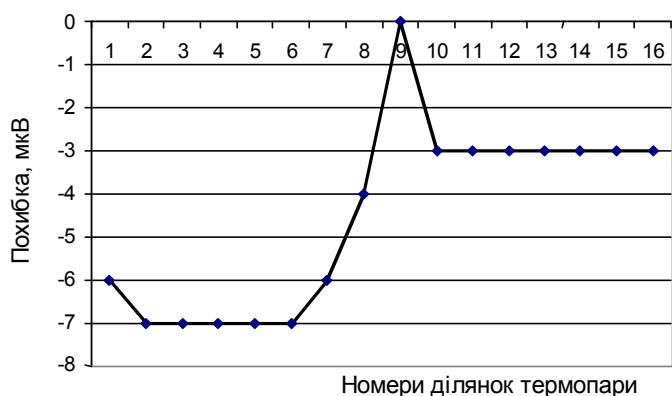
Рис. 7. Невиключена похибка від неоднорідності головної термопарі ТЕП з КПТП
