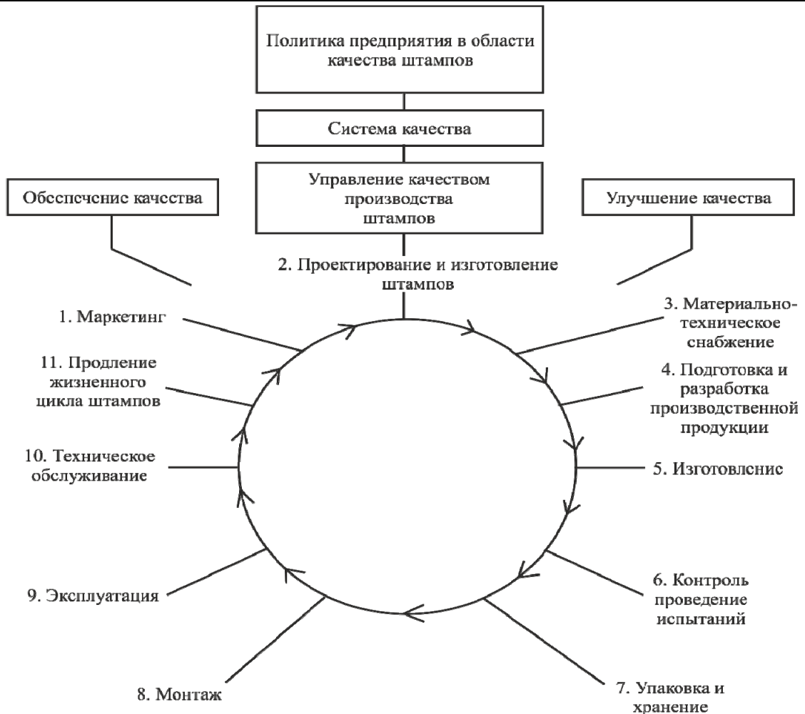
Рис. 2 Модель управления качеством конструкторско-технологического проектирования и изготовления деталей штампов
