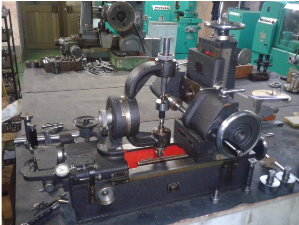
Рис. 2. Установка для контроля геометрической формы пар шестерен
