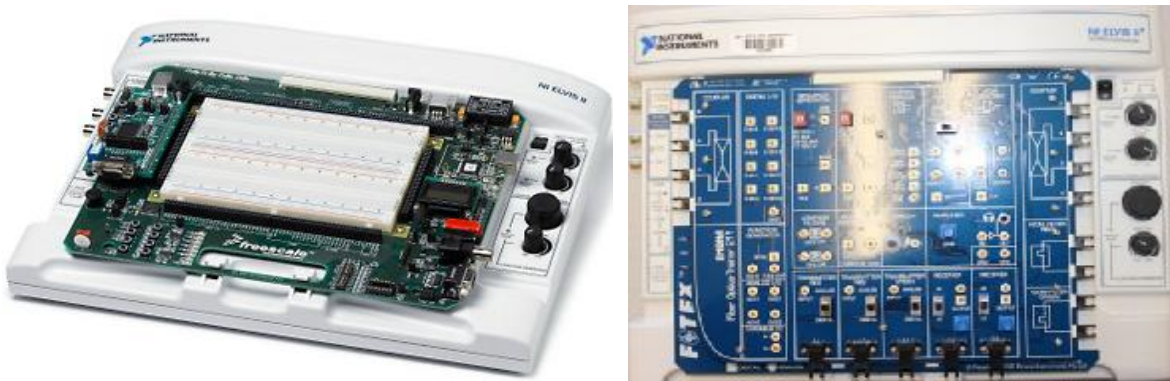
Рис.12. Зовнішній вигляд лабораторної установки «Вивчення та програмування мікроконтролерів» Освітній центр National Instruments
