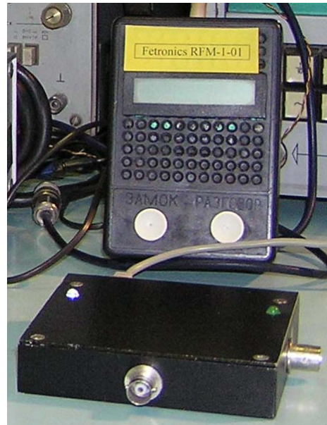
Рис. 3. Частотомер коинциденции и измерительный преобразователь частоты
