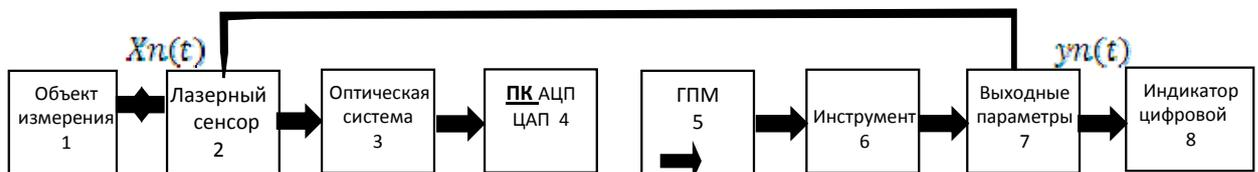
Рис. 1. Структурная схема измерительного канала активного лазерного прибора
