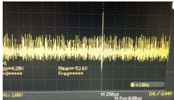
Рис. 8. Осцилограма хаотичних коливань генератору на основі біполярно-польової транзисторної структури
