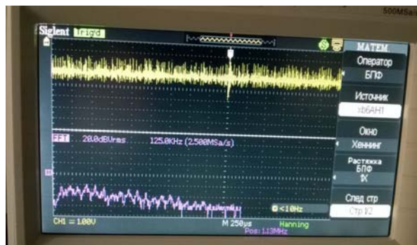
Рис. 9. Осцилограма та амплітудо-частотний спектр хаотичних коливань генератору
