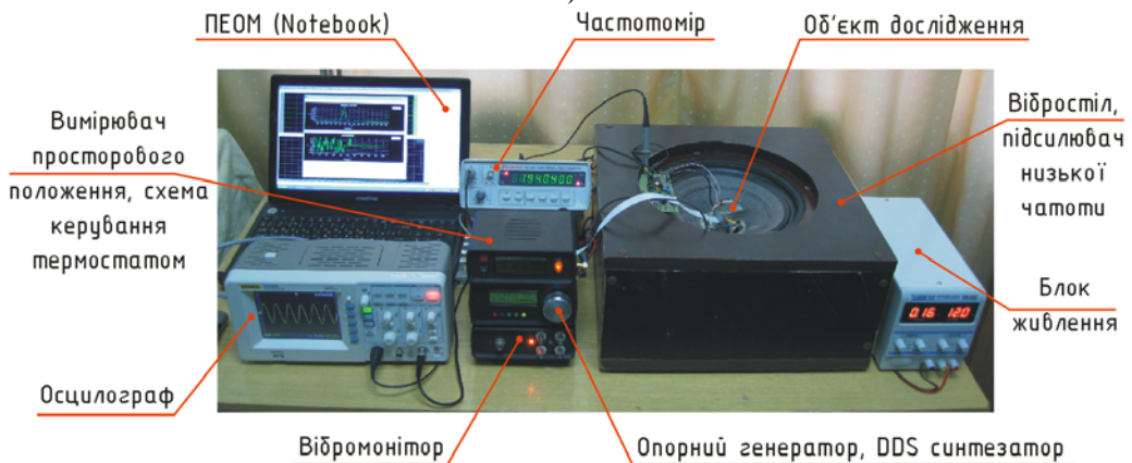
Рис. 4. Обладнання для комплексного дослідження характеристик кварцових резонаторів: а) структурна схема; б) фото системи
