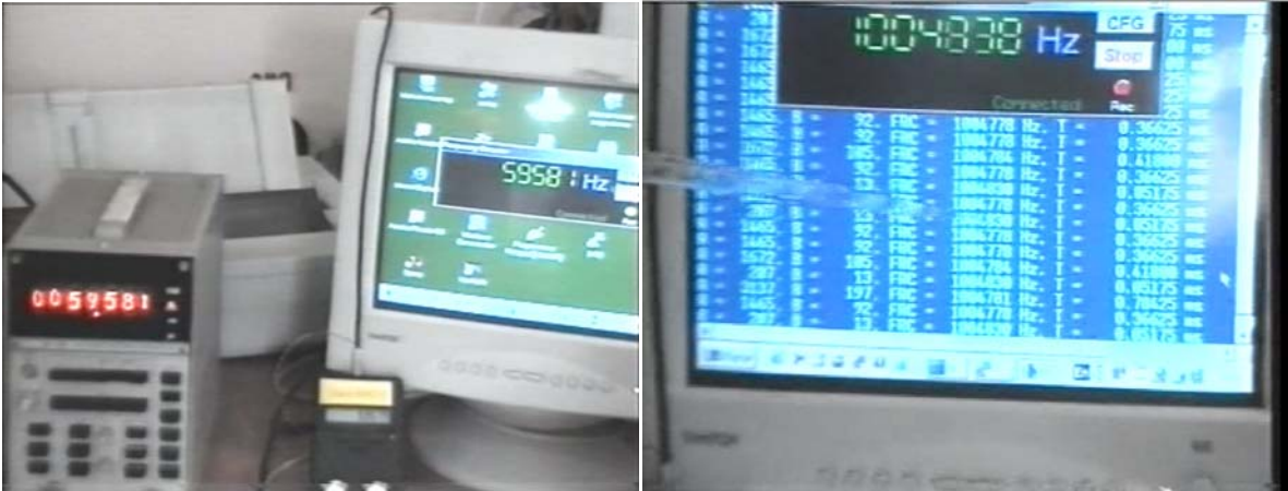
Рис. 17. Вимірювання частоти за методом коінциденції (1 Гц за час 1 мілісекунда)
