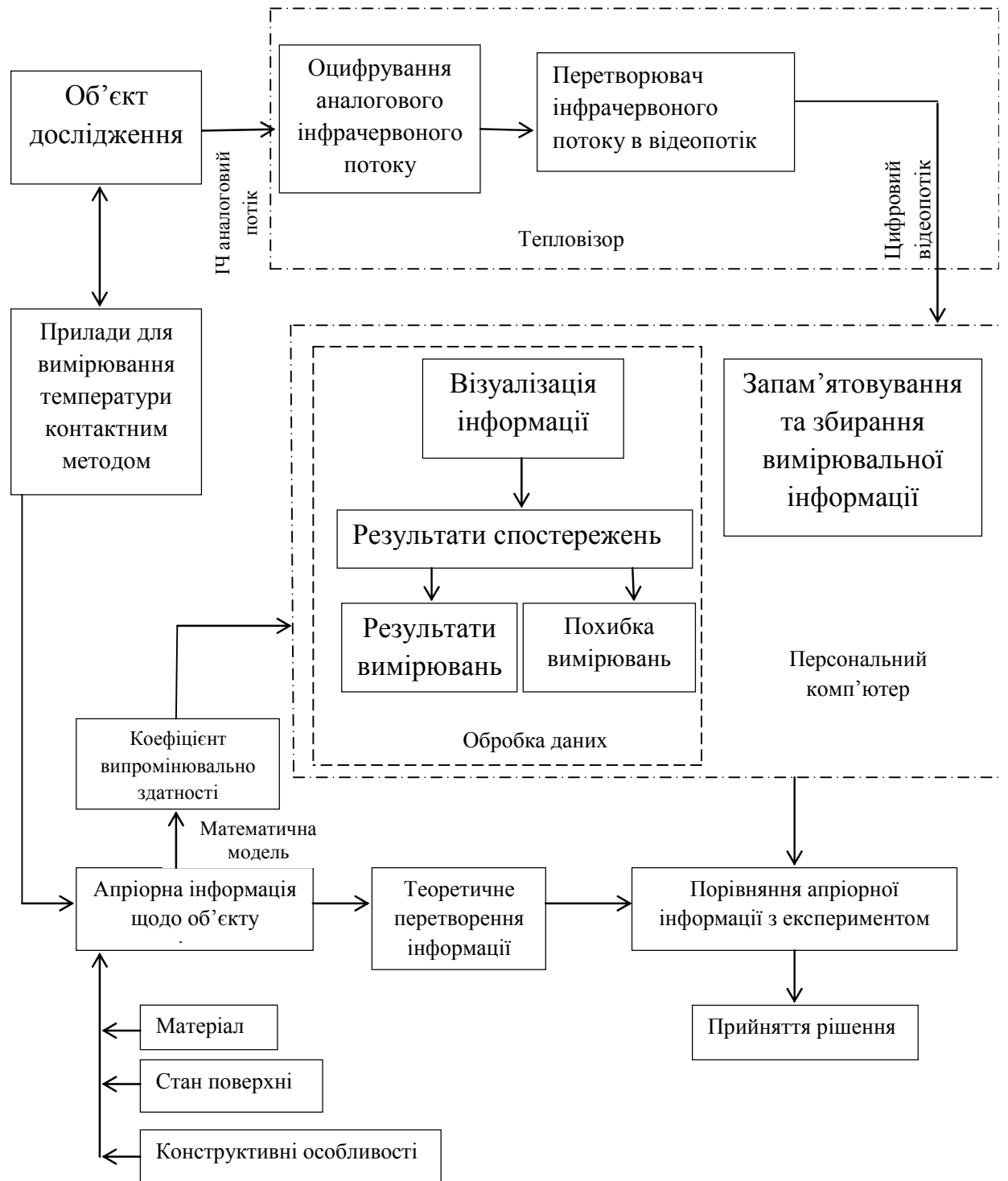
Рис. 2. Структурна схема такої вимірювальної системи
