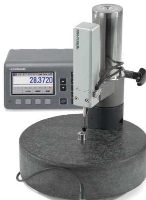
Рис. 3. ОП з інкрементним фотоелектричним перетворювачем
