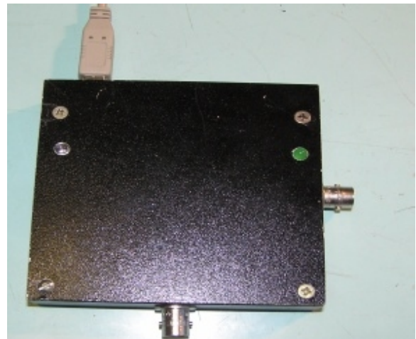
Рис. 5. Частотомір FETRONICS RFM-01, і вимірювальний перетворювач частоти за методом коінциденції
