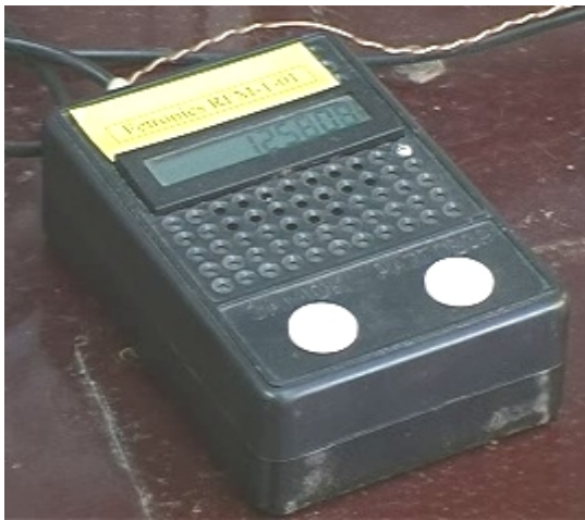
Рис. 5. Частотомір FETRONICS RFM-01, і вимірювальний перетворювач частоти за методом коінциденції
