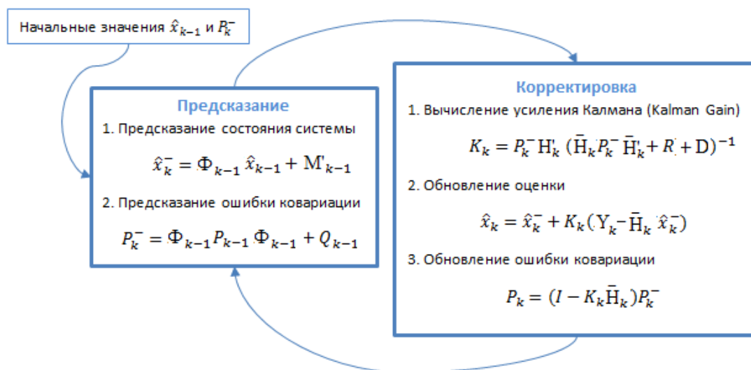
Рис.5 Алгоритм адаптивного фильтра Калмана
