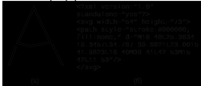
Рис. 3. Приклад векторного зображення (а) та його аналітичного представлення (б) у форматі SVG
