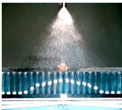
Рис. 2 – Распределение плотности орошения форсункой фирмы lechler
