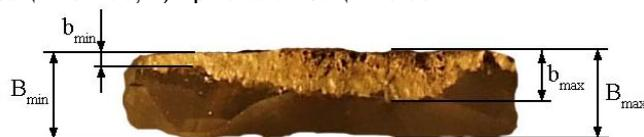
Рис. 2 – Схема обмера образца шлака для определения степени кристалличности
