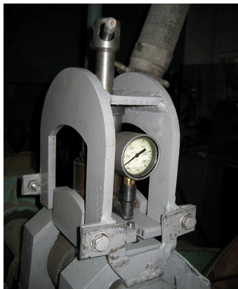
Рис. 1 – Установка для замера величины силы обжатия
