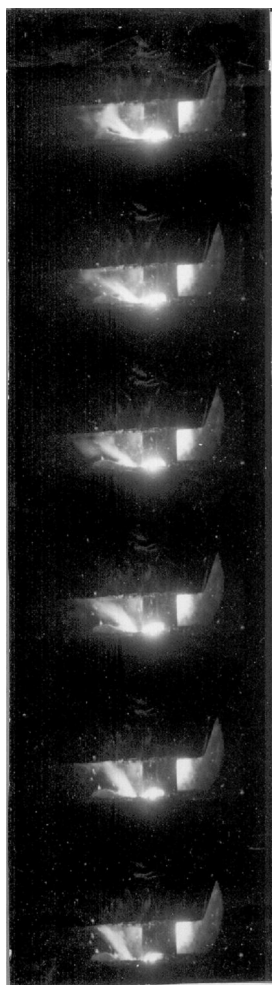
Рис. 2 – Кинограмма процесса сварки составным электродом в аргоне: Интервал между кадрами 6 \cdot 10^{-4} с, Направление сварки – слева направо
