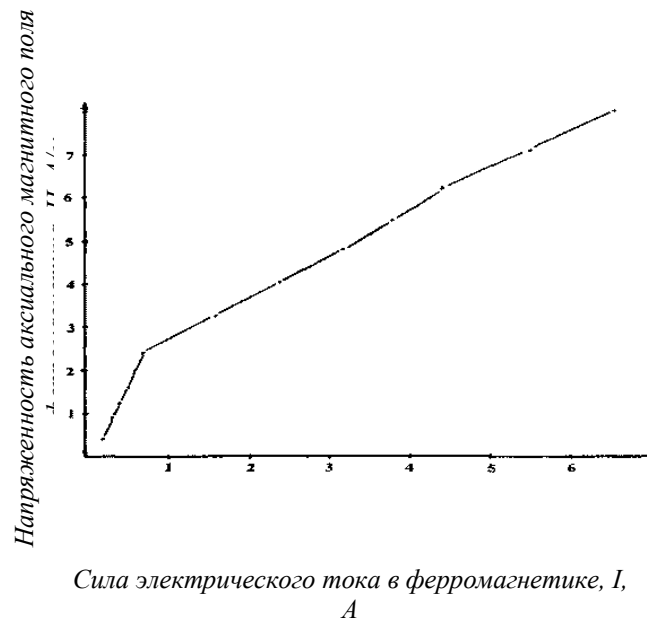
Рис.2 - Зависимость напряженности аксиального магнитного поля ферромагнетика от величины переменного электрического тока
