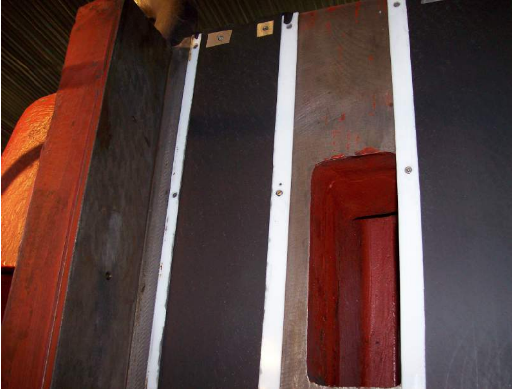
Рис. 5 – Поверхность восстановленных направляющих на расточной бабке после полимеризации материала „Моглайс FL/P”
