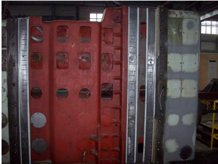
Рис. 1 – Три направляющие на расточной бабке зачищены и по их краям закреплены ограничители толщины слоя „Моглайса PL/P” – тефлоновые полоски толщиной 2 мм
