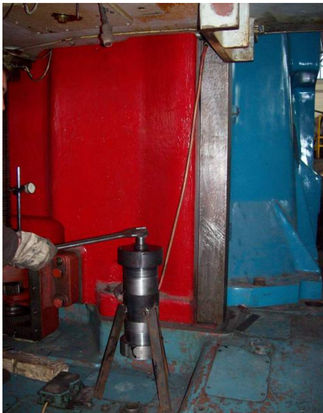
Рис. 4 – Нагнетание материала „Моглайс FL/P” в зазор между направляющей на станине и металлической поверхностью на расточной бабке
