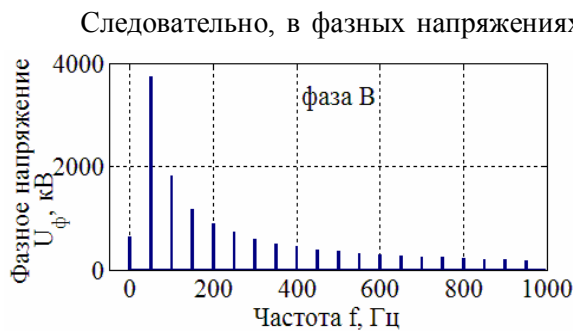
Рис. 7 – Амплитудно-частотный спектр фазного напряжения при однополярной дуге
