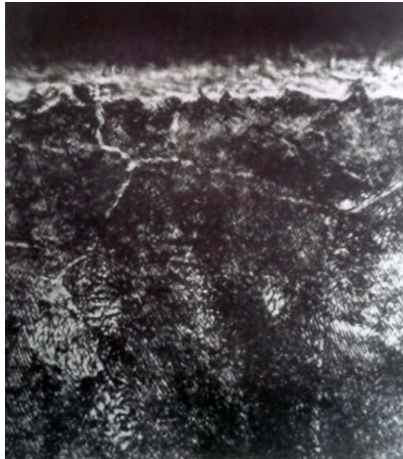
Рис. 1 – Микроструктура покрытия на стали У10 ( \times 600 ) после диффузионного хромирования в смеси №2
