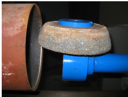
Рис. 3 – Компоновка обработки отверстия в цилиндре
