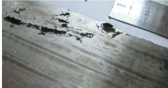
Рис. 1 – Литейные дефекты в сечении отливки из углеродистой стали 35Л
