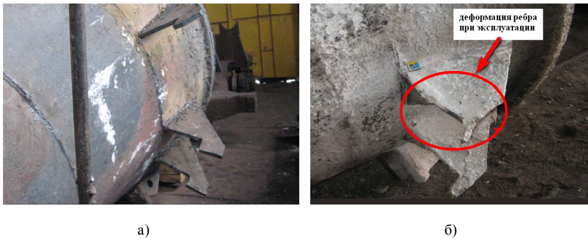
Рис. 5 – Фрагмент лито-сварной конструкции чаши на стадии изготовления (а) и через 12 месяцев эксплуатации (б)
