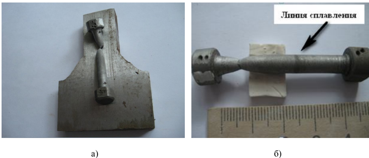
Рис. 3 – Испытания лито-сварного соединения «Сталь 35Л-09Г2С»: а – схема отбора пробы, б – образец после испытания
