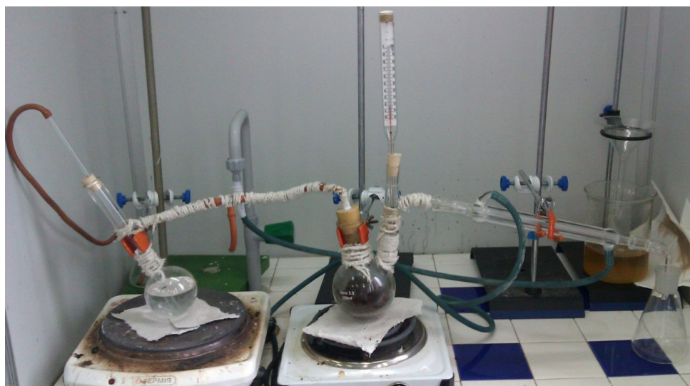
Рис. 3. Експериментальна установка для відгонки кавових ароматів з водяною парою.
