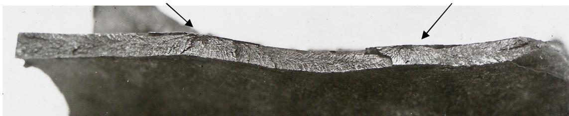
Рис. 3 – Характер изломов крупных осколков разрушенных баллонов (очаги разрушения указаны стрелками)
