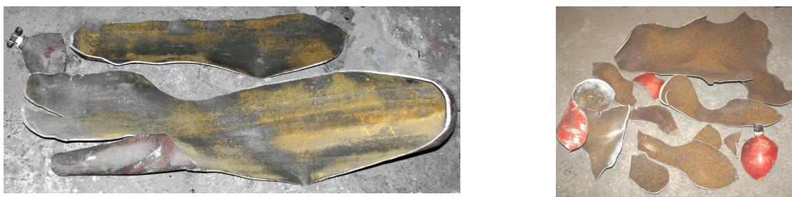
Рис. 1 – Характер разрушения корпусов баллонов под действием статистических сил, вызванных внутренним давлением
