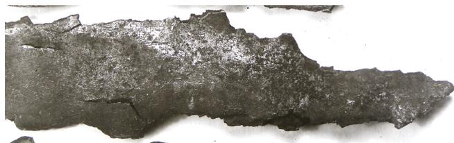
Рис. 4 – Форма мелких осколков при разрушении в результате взрыва газа внутри сосуда
