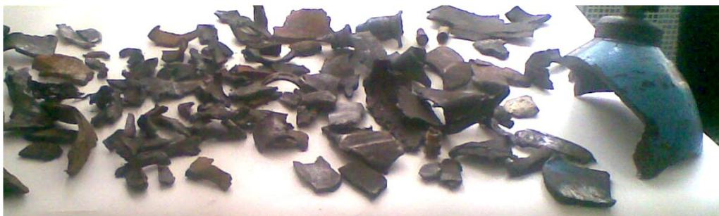
Рис. 2 – Характер разрушения корпусов баллонов под действием динамических сил, вызванных взрывом газа внутри сосуда
